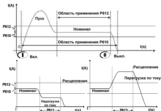
Рисунок 6.8 - Уровни срабатывания недогрузки и перегрузки по току
