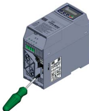
(b) Removal of the fan (b) Remoción del ventilador (b) Remoção do ventilador
