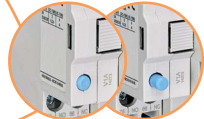
→ Розчеплення при перевантаженні та короткому замиканні (спрацює нижня група контактів)
