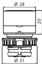
Кнопка-модуль заглиблена (з підсвічуванням)
