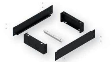
Чотирьохелементний цокль з поперечною балкою для посилення жорсткості та кріплення кабелю
